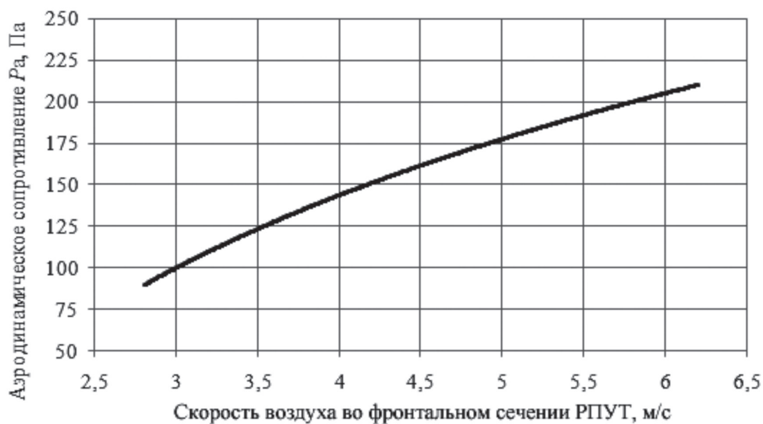
Рисунок 10.11 – Зависимость аэродинамического сопротивления РПУТ от скорости воздуха во фронтальном сечении
